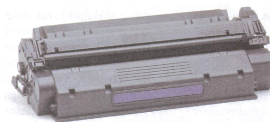
Lézernyomtató toner. A toner nemcsak a festékpórt, hanem a hengert is tartalmazza. Mivel környezetszennyező, nem szabad a kukába dobni
