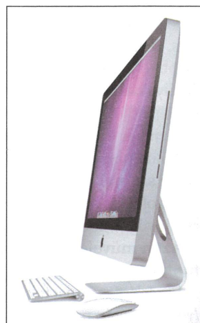
iMac: az alaplap is a monitorba van beépítve
