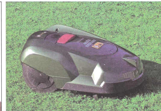
A robotfűnyíró folyamatosan gondozza a pázsitot. Ha lemerül, visszamegy a töltőjéhez, és rácsatlakozik
